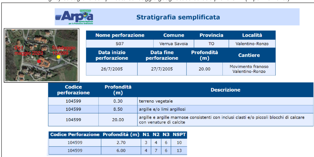
Fig. 8) Stratigrafia semplificata sondaggio geognostico ed esiti prove SPT (Arpa Piemonte)
